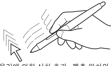
화면 유리에 의한 시차 효과. 펜촉 위치와 화면 커서가 정렬되지 않은 상태.
