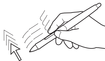
디스플레이 화면 유리로 인한 시차 효과. 펜촉과 화면 커서의 위치가 얼마나 정렬되어 있지 않은지 확인하십시오.
