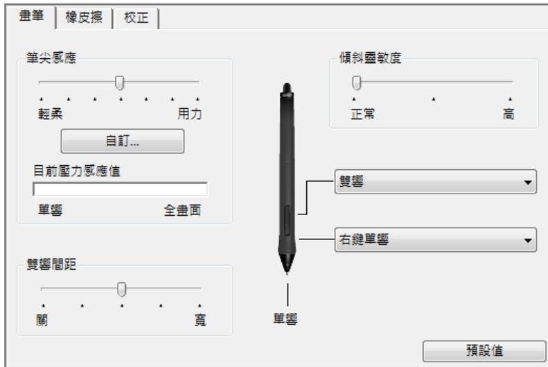
拖動以增加或減少〔傾斜敏感度〕。在支援傾斜的應用程式裡測試新的設定。
