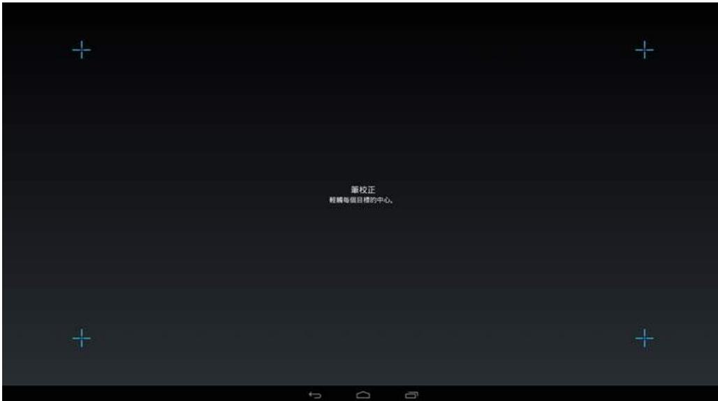
2. 在測試螢幕上劃動幾次，以檢查校正。如果結果滿意，則按一下 [ 儲存 ] 接受校正。如果由於任何原因想重複校正，則按一下 [ 重新校正 ]。您可隨時從「Wacom 桌面中心」重新校正。
